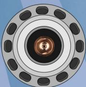
Die stark konische Absaugaufnahme ist unlösbar mit dem Absaugrohr verklebt !
